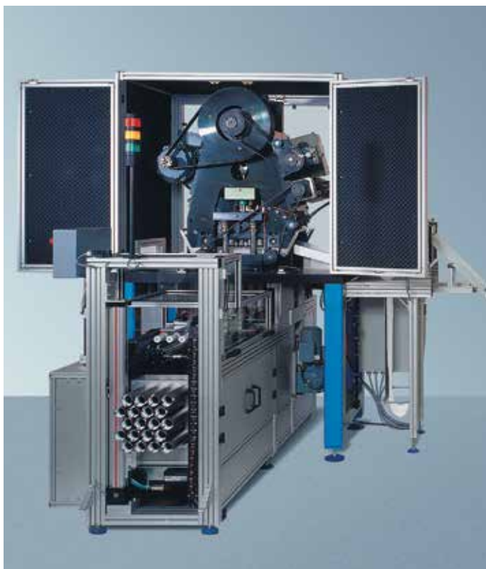
Pressa di stampaggio con calotta insonorizzante
