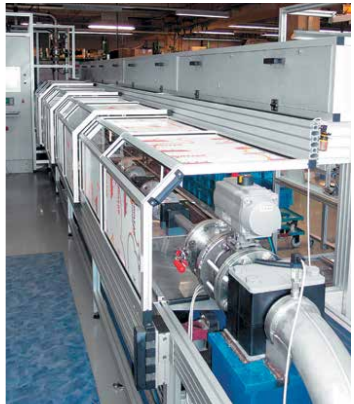
Copertura scorrevole telescopica a quattro elementi
