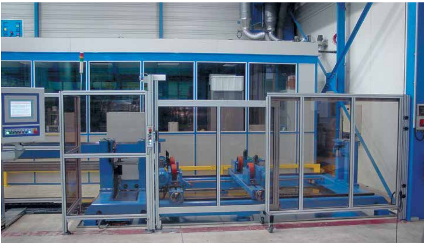
Pannellatura per impianto di sbavatura con vetro di sicurezza
