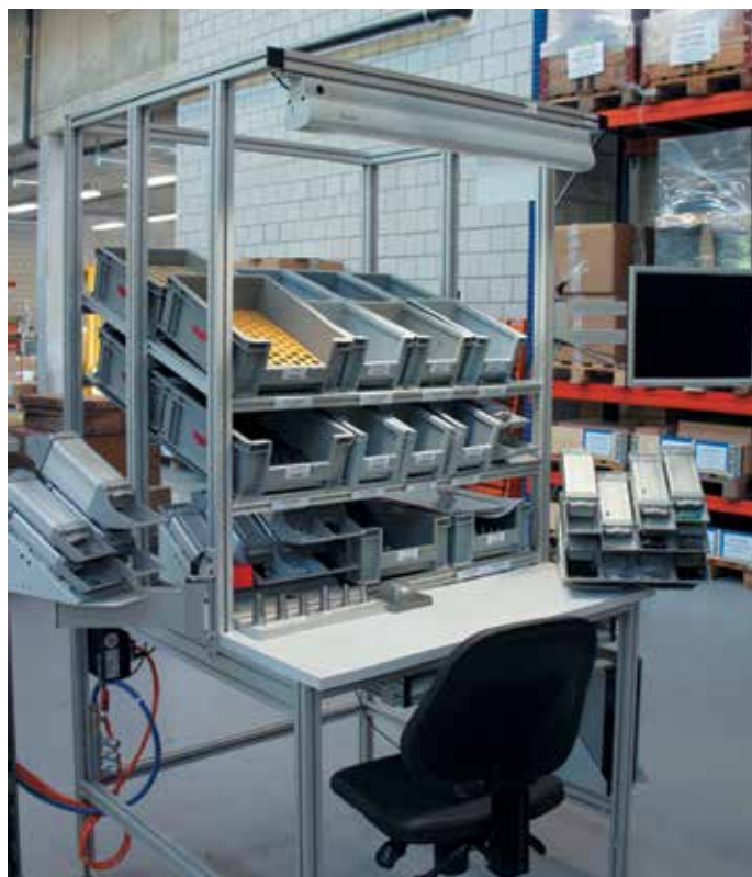
Postazione di lavoro speciale
