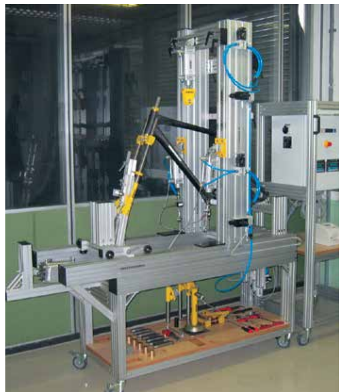
Stazione di prove su telai al carbonio per biciclette
