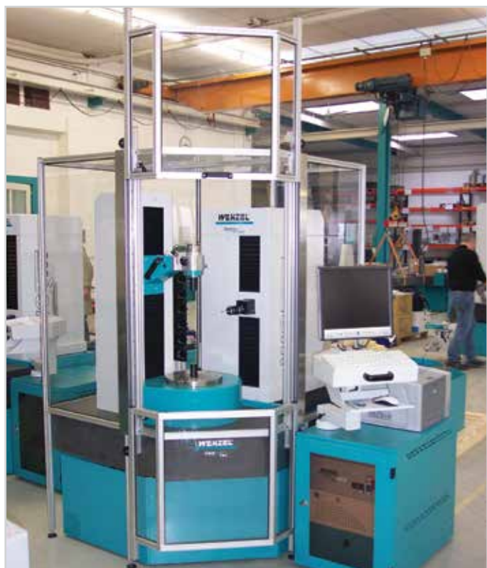
Finestre con doppio supporto angolato e compensazione del peso
