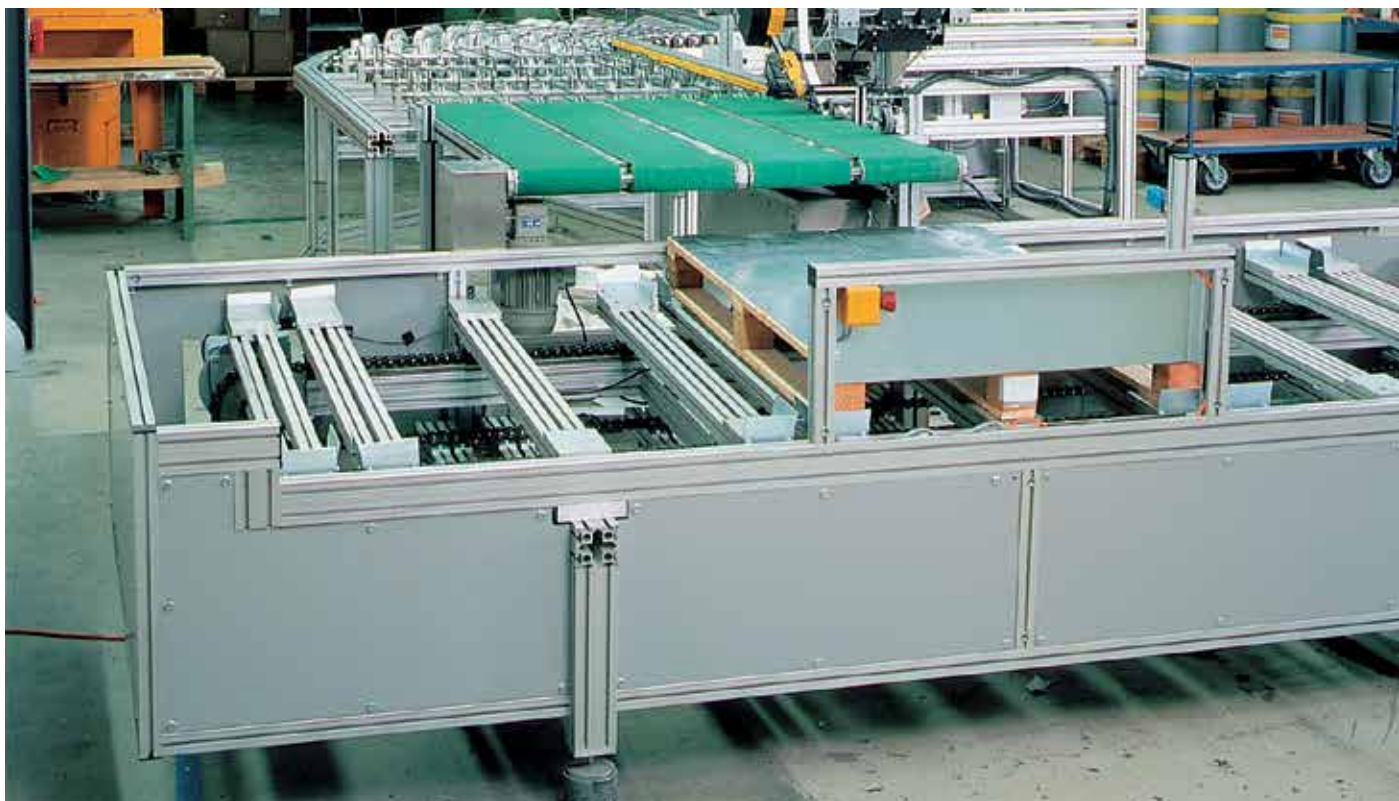
Impianto di palletizzazione
