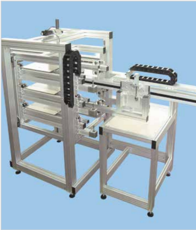
Struttura portante con cassette su moduli lineari
