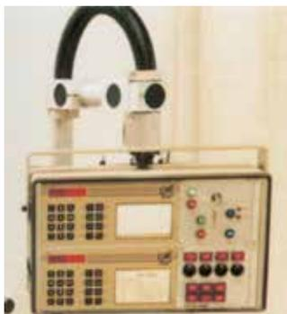
Fissaggio regolabile per centralina di controllo.
