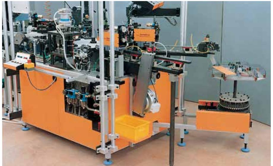
Guida per pannello di protezione su stazione automatica di assemblaggio con equilibratore del peso all'interno dei tubi in alluminio.
