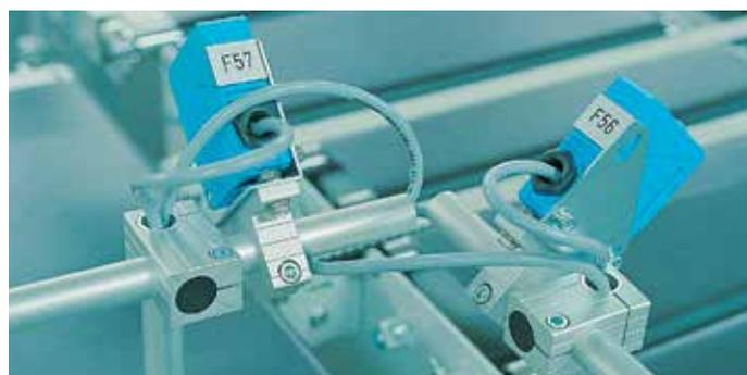
Fissaggio di fotocellule, facilmente regolabile.
