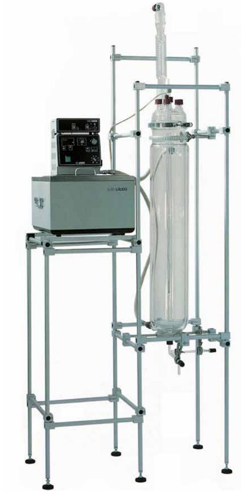
Reattore a colonna a bolle per fase liquida/gassosa con mantello di raffreddamento e sistema di iniezione gas.
