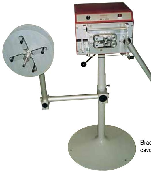
Braccio orientabile con sostegno della bobina di cavo per sistema automatico di spellatura cavi.
