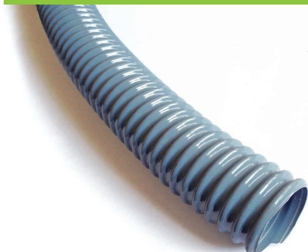
Tubo in PVC plastificato con spirale anti-collassamento in PVC rigido. Ottimo per trasporto in depressione di trucioli e polveri. Tubo particolarmente adatto per applicazioni in depressione con aspiratori a canale laterale in quanto dotato di una struttura di rinforzo a spirale in PVC rigido annessa nel materiale del tubo. Resistente allo schiacciamento dovuto alla depressione che si crea all'interno.
