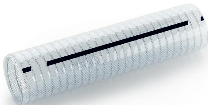
Tubo in PVC plastificato con spirale anti-collassamento in acciaio e rinforzo a rete in poliestere annegati in due strati separati in modo da non creare scollamenti e bolle d'aria fra spirale e rete.
