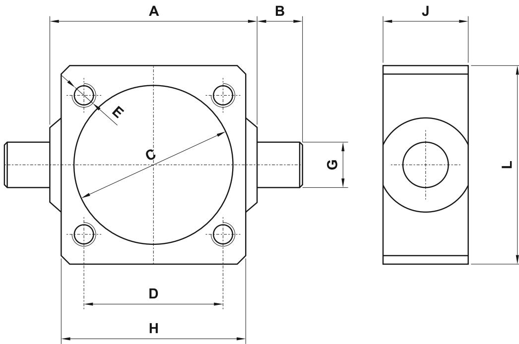
Questa cerniera intermedia può essere montata solo su cilindri a tubo tondo con tiranti. Al momento dell'ordine dei cilindri specificare chiaramente questa caratteristica, fornendo anche precise indicazioni riguardo alla posizione di montaggio della cerniera sul cilindro.
