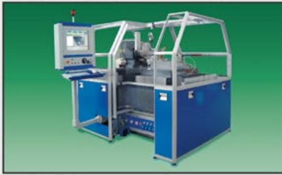
Sistemi di montaggio rapido e modulare per telai strutturali di macchine, movimentazioni, protezioni antinfortunistiche ed insonorizzanti.
