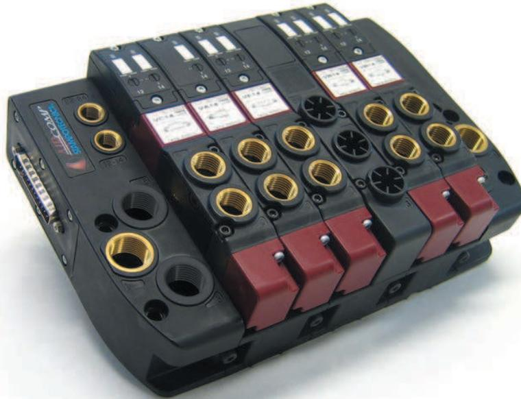
La linea di valvole SIM 150 unisce flessibilità e semplicità di montaggio tipiche delle valvole su sottobase ai vantaggi del sistema di cablaggio elettrico e pneumatico delle batterie più avanzate. Un particolare doppio elettropilota posto su un solo lato della valvola, in grado di alimentare anche valvole bistabili, riduce sensibilmente l'ingombro totale della batteria.
