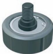
**Per interventi di manutenzione:** rimontando il perno non lubrificare il filetto e applicare una **coppia di serraggio max 55 Nm**.
